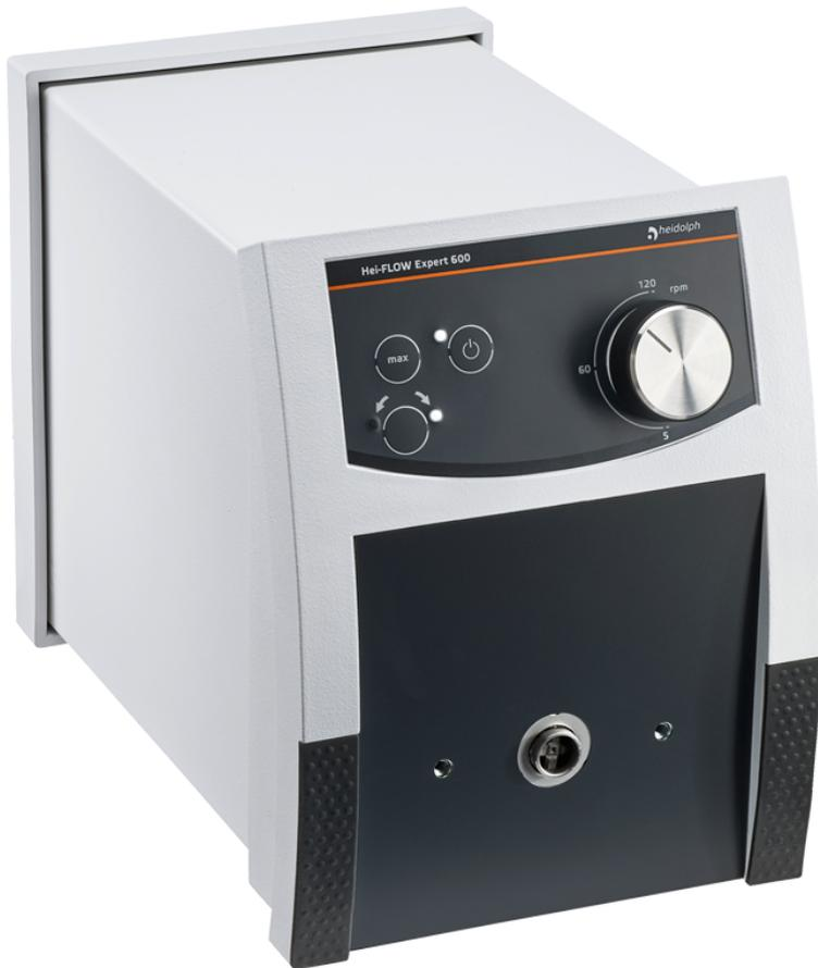
Questo modello ha una portata di 2,0 – 4.056 ml/min ed è adatto al funzionamento con teste monocanale. L'interfaccia analogica permette di controllare tutte le funzioni dall'esterno. L'accuratezza del  $\pm 0,5\%$  e la velocità di flusso compresa fra 24 e 600 giri/min offrono condizioni ottimali durante il processo. Inoltre, l'utilizzo del comando a [pedale](#) opzionale permette di proteggere i mezzi sensibili dalle sollecitazioni esterne.
