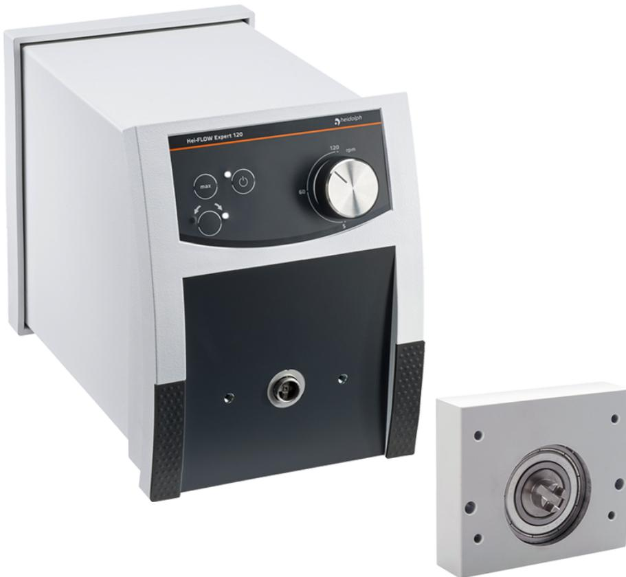
Il motore della pompa del modello 120 della serie Hei-FLOW Expert può funzionare con teste monocanale o multicanale. Con teste monocanale la portata varia da 0,38 a 813 ml/min, mentre con teste multicanale è compresa fra 0,005 e 329 ml/min.
