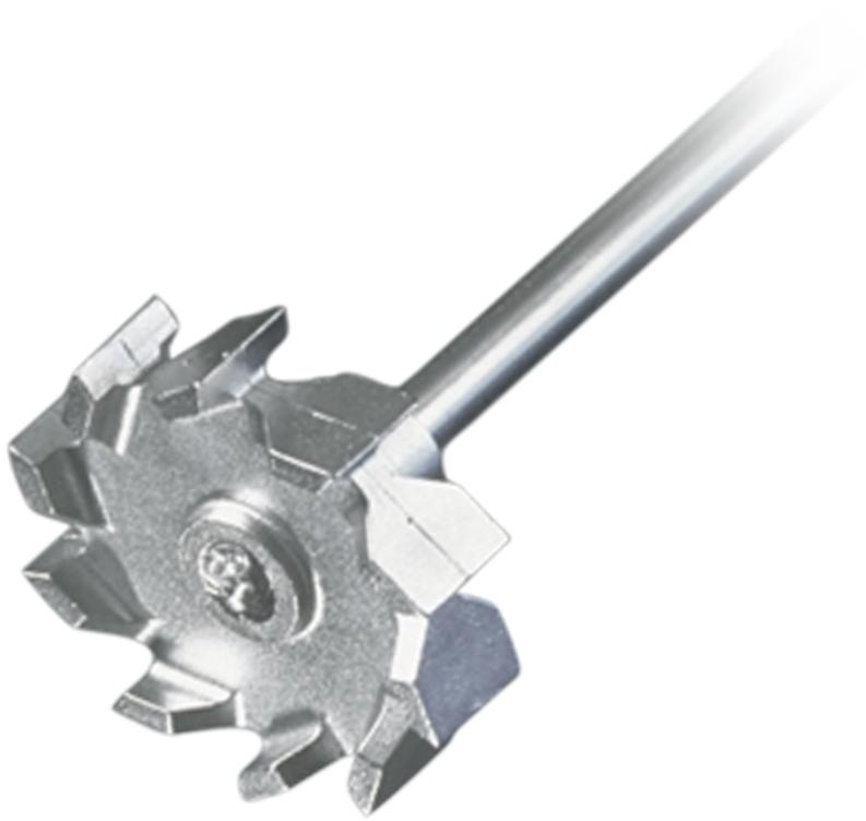
Grâce à la forme crénelée de la pale d'agitation, la tige d'agitation type flux radial TR 21 est parfaitement adaptée pour fabriquer des émulsions ainsi que pour apporter du gaz à des fluides ou à les faire mousser dans des récipients qui affichent les caractéristiques suivantes :
