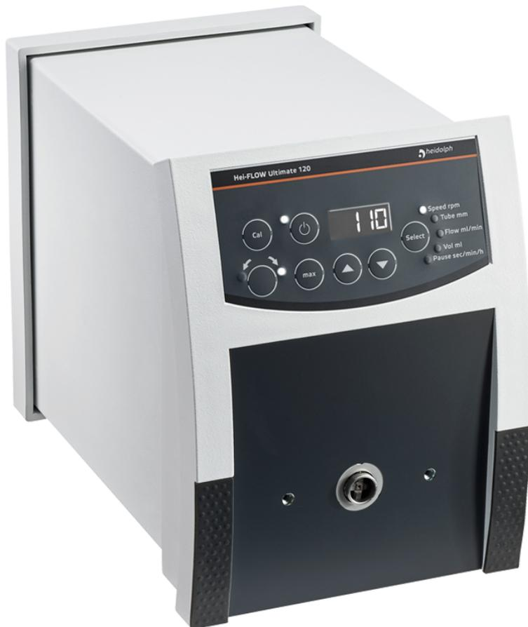
Besonders im pharmazeutischen, kosmetischen oder Nahrungsmittelbereich ist das akkurate Dosieren von besonderer Wichtigkeit. Nachvollziehbare Prozessbedingungen sind Voraussetzung für die sichere Förderung sensibler Medien. Dies wird durch eine Regelgenauigkeit von  $\pm 0,5\%$  sowie eine genaue Einstellung der Drehzahl (5 – 120 U/min) sichergestellt.
