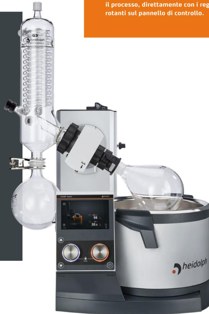
La velocità di rotazione e la temperatura del bagno termostatico possono essere impostate esattamente dal display touch digitale o, per un accesso veloce durante il processo, direttamente con i regolatori rotanti sul pannello di controllo.
