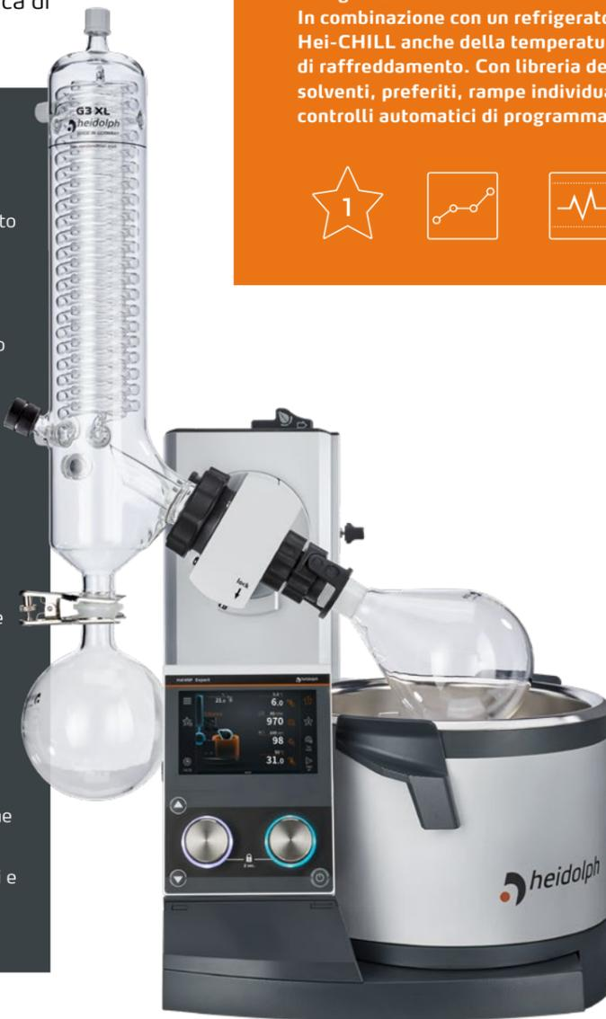
Pannello di controllo per il comando e la regolazione centrale del vuoto. In combinazione con un refrigeratore Hei-CHILL anche della temperatura di raffreddamento. Con libreria dei solventi, preferiti, rampe individuali e controlli automatici di programma
