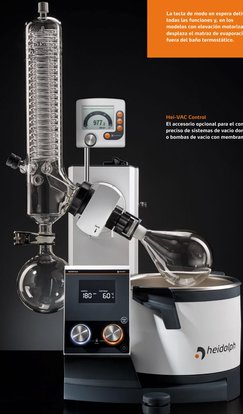
La tecla de modo en espera detiene todas las funciones y, en los modelos con elevación motorizada, desplaza el matraz de evaporación fuera del baño termostático.
