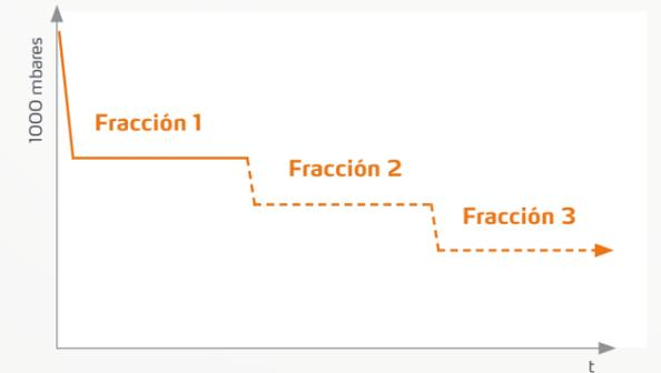
Con DAA, se puede iniciar un proceso de destilación de destilación totalmente automatizado ya durante la fase de calentamiento del baño termostático. La presión del sistema se ajusta dinámicamente a la temperatura variable del baño termostático hasta que se alcanza la temperatura establecida.
