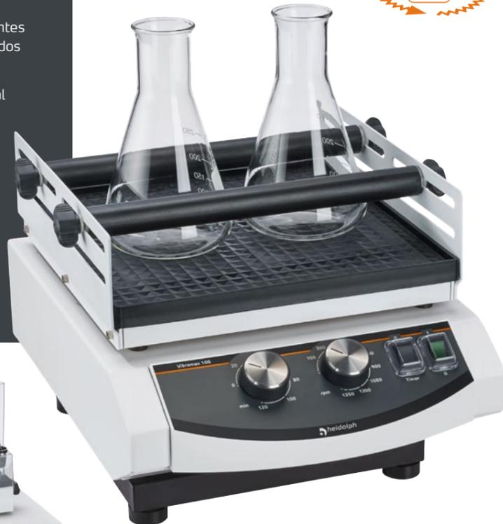
Múltiples posibilidades gracias a la combinación de rodillos de sujeción y abrazaderas, así como otros accesorios para tubos de ensayo con hasta 49 muestras simultáneas.
