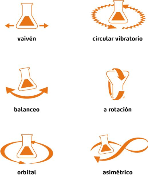
Seis movimientos de agitación distintos, en una, dos y tres dimensiones. Además, cada tipo de movimiento puede variar en amplitud e inclinación.
