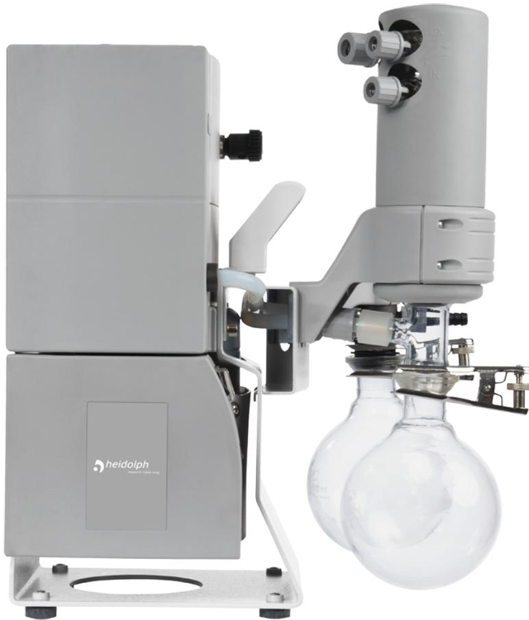
Mit Kondensatkühler und Ansauger
