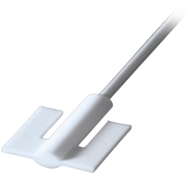
Insbesondere bei Anwendungen mit sehr viskosen Medien kommt es darauf an, ein Rührorgan im Einsatz zu haben, das den Mischvorgang bis an die Ränder des Gefäßes ermöglicht. So erklärt sich die Form des Ankerrührers und die Breite des Rührblatts von 60 mm.
