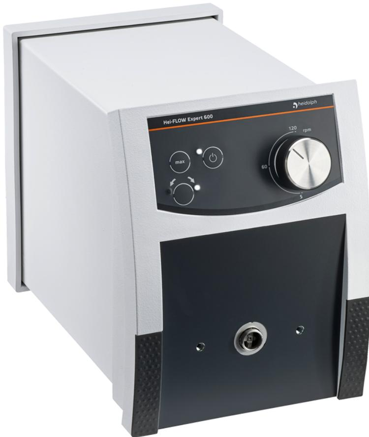
Dieses Modell hat eine Flussrate von 2,0 – 4.056 ml/min und ist für den Betrieb mit Einkanalpumpenköpfen ausgelegt. Die analoge Schnittstelle macht es möglich, dass alle Funktionen extern gesteuert werden können. Eine Regelgenauigkeit von  $\pm 0,5\%$  und eine Fördergeschwindigkeit von 24 bis 600 U/min bieten optimale Prozessbedingungen. Zusätzlich können empfindliche Medien vor Einfluss geschützt werden, in dem der optionale [Fußschalter](#) verwendet wird.
