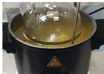
Nur mit Hilfe eines externen Temperaturfühlers lässt sich die Reaktionstemperatur exakt messen und regulieren.
