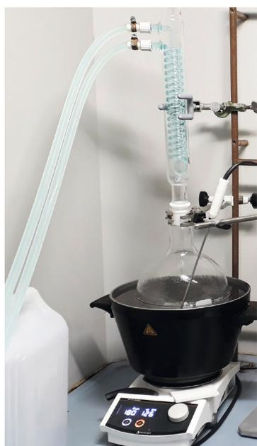
Abb. 1 Wassergekühltes Reflux System
